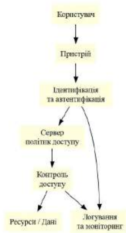
Рис. 3. Модель контролю доступу на основі Zero Trust Architecture
